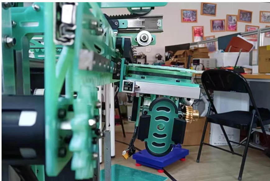
图 46 侧向夹取机构塌陷
