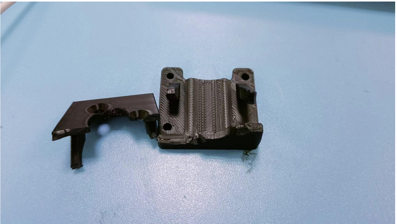
图 51 断裂的电机架
